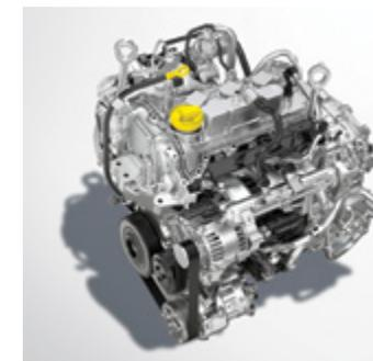
Moteur HR-10 1.0ℓ turbocompressé
